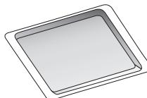
Plech na pečenie používajte len s funkciami, ktoré umožňujú konvekčnú prípravu jedál; nikdy ho nesmiete použiť v kombinácii s mikrovlnami.
